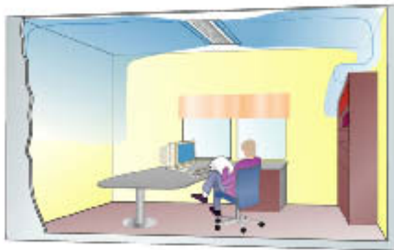
Kuva 36. Käytävä - ulkoseinän suuntainen jäädytyspalkki solukonttorissa.
