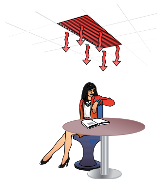
Kuva 10. Lämpimän pinnan vaikutus pään yläpuolella. \Delta T_{pr} < 5K .
