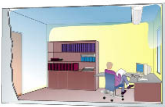
Kuva 38. Etureunaan asennettu ilmastointipalkki solukonttorissa.
